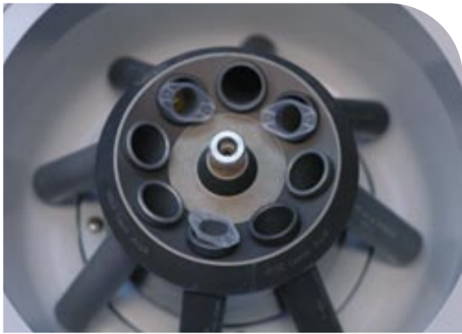
LES PRÉLÈVEMENTS GRAISSEUX SONT CENTRIFUGÉS PENDANT 3 MN À 3 000 TOURS/MN.
